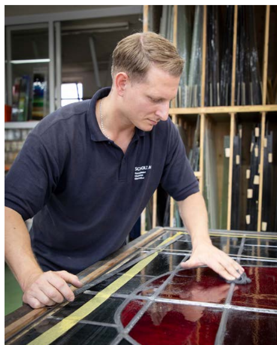
Roger Scholz putzt die Fenster (links), löst das spröde Randblei (oben rechts) und sucht für gesprungene Glasfragmente die passende Farbnuance (unten rechts).
